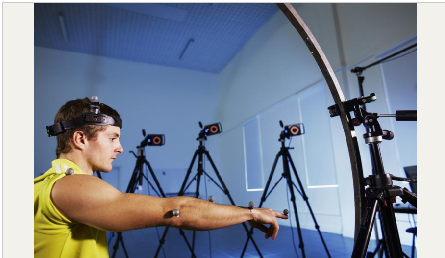
Capture en 3D, par des caméras infrarouges, de mouvements du membre supérieur en laboratoire, sur un sujet volontaire. Des marqueurs réfléchissants sont placés sur le corps pour enregistrer sa position dans l'espace. © Inserm/Guénet, François
