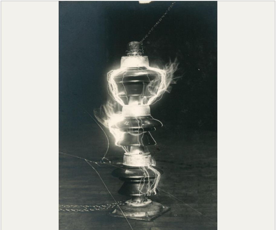
Contournement à 600.000 volts sur un pilier isolateur. Laboratoire haute tension. Service communication Merlin Gerin, Arras, env. 1922-1929. Collection Académie François Bourdon - Le Creusot (0001ZH000074-01)
